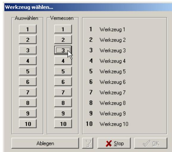
3. Danach den Job laden und mit dem eingelegten Werkzeug den Nullpunkt und speziell den Z-Nullpunkt bestimmen. Dies kann in der gewohnten Weise z.B. durch Ankratzen der Oberfläche erfolgen.
