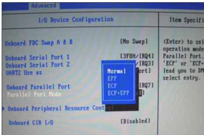
Bei den Einstellungen für den Modus der parallelen Schnittstelle wählen Sie am besten *Normal* oder *SPP* oder *Compatible mode*. Die Bezeichnung variiert von BIOS zu BIOS. Auf keinen Fall sollten Sie einen der modernen bidirektionalen Modi einstellen.
