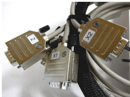
Abb. 13: Anschluss ST u. Motorleitung
