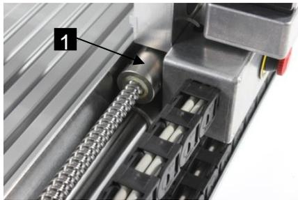
Abb. 35: Kugelgewindespindel X-Achse
