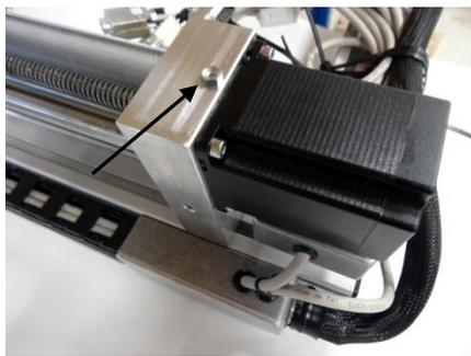
Abb. 31: Schmiernippel X-Achse
