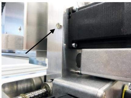
Abb. 32: Schmiernippel Y-Achse
