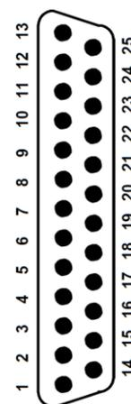
Pin Nr. 1 ist ein Open-Collector-Signal, d.h. es wird nach Masse geschaltet, wenn der Spindelmotor eingeschaltet wird, und kann zur Freischaltung (Start/Stop-Eingang) eines Frequenzumrichters verwendet werden (max. 30V 50mA). Pin Nr. 18 ist das analoge Drehzahlsignal. Es ist kurzschlussfest, so dass kein Schaden verursacht wird, falls irrtümlich ein normales LPT-Kabel (Pin 18=Masse) angeschlossen wird.
