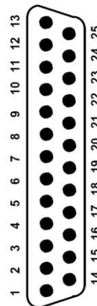
Für die Ansteuerung eines Werkzeugwechslers und Frequenzumrichters ist ein 2. LPT-Port vorgesehen (siehe Bild oben rechts). Der Stecker zum PC ist männlich, zum Wechsler/FU weiblich.
