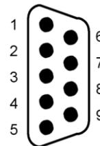
Bei Motoren mit 3A oder höherem Strom muss ein Kabelquerschnitt von mindestens 0,5mm<sup>2</sup> verwendet werden, und je Ader immer beide Pins angeschlossen werden. Bei Motoren mit kleinerem Strom sind 0,34mm<sup>2</sup> und ein Pin ausreichend. Die Abschirmung kann alternativ an Pin 5 oder den Blechkragen des Steckers angeschlossen werden. Die Motorausgänge sind kurzschlussfest (Windungs- und Masseschluss).
