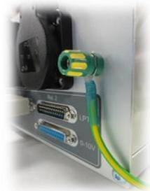
Bei Maschinen mit Masseanschluss für den Gesamtschirm, wird hier das Massekabel der Maschine angeschlossen.
