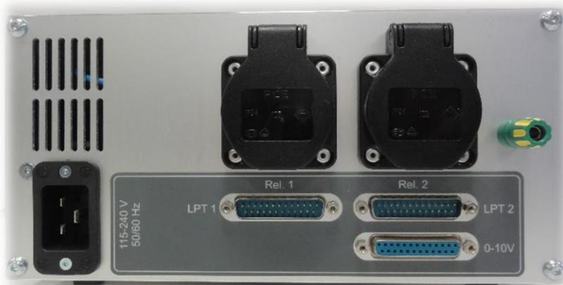
Der Anschluss des Steuerungs-PC erfolgt über einen 25-poligen SUB-D-Stecker (LPT=Parallel Port) an der Rückwand. Die meisten Signale für die Grundfunktionen (Takt/Richtung, Spindel an/aus usw.) sind am linken Stecker (LPT1) verfügbar. Der Steckverbinder an der Steuerung ist männlich, d.h. zur Verbindung mit dem PC ist ein 1:1-Verlängerungskabel mit männlichem/weiblichem Stecker nötig.
