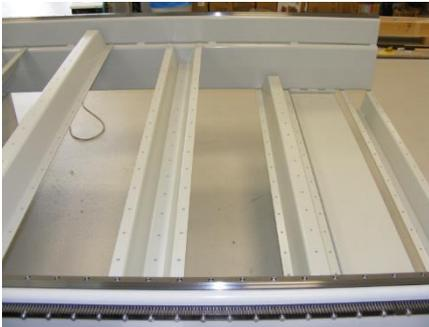
Abb. 25: Tischauflageverstrebenungen auf vier Höhen montierbar
