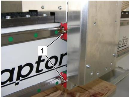
Abb. 41: Schmiernippel Y-Achse
