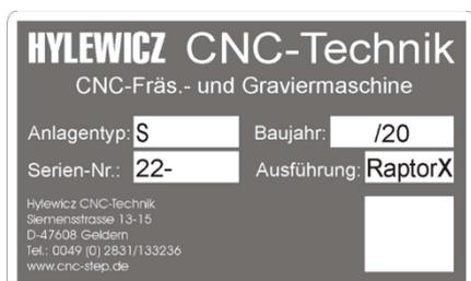
Das Typenschild befindet sich am Rahmen der Maschine seitlich neben dem Schaltschrank und beinhaltet folgende Angaben:
