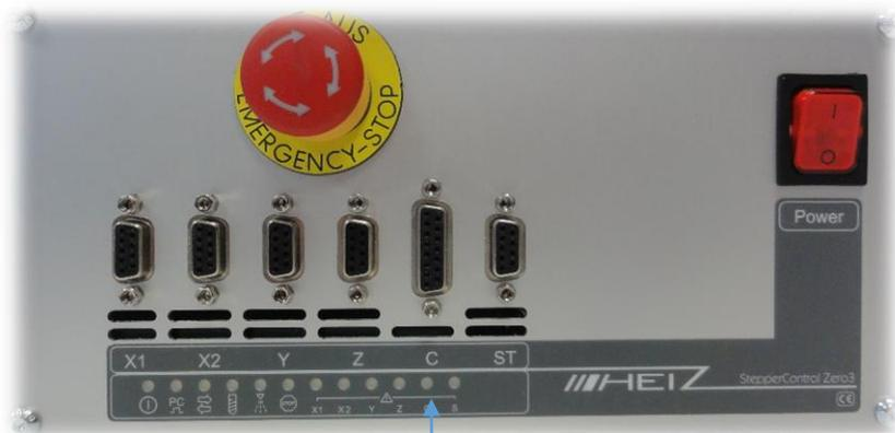
Abb.3: Zero-3 Steuerung
