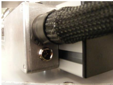
Abb. miniXLR Stiftbuchse
